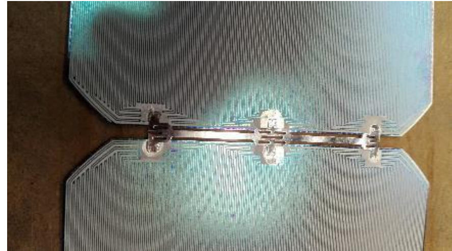
DETALLE DE UNIÓN ENTRE CÉLULAS
